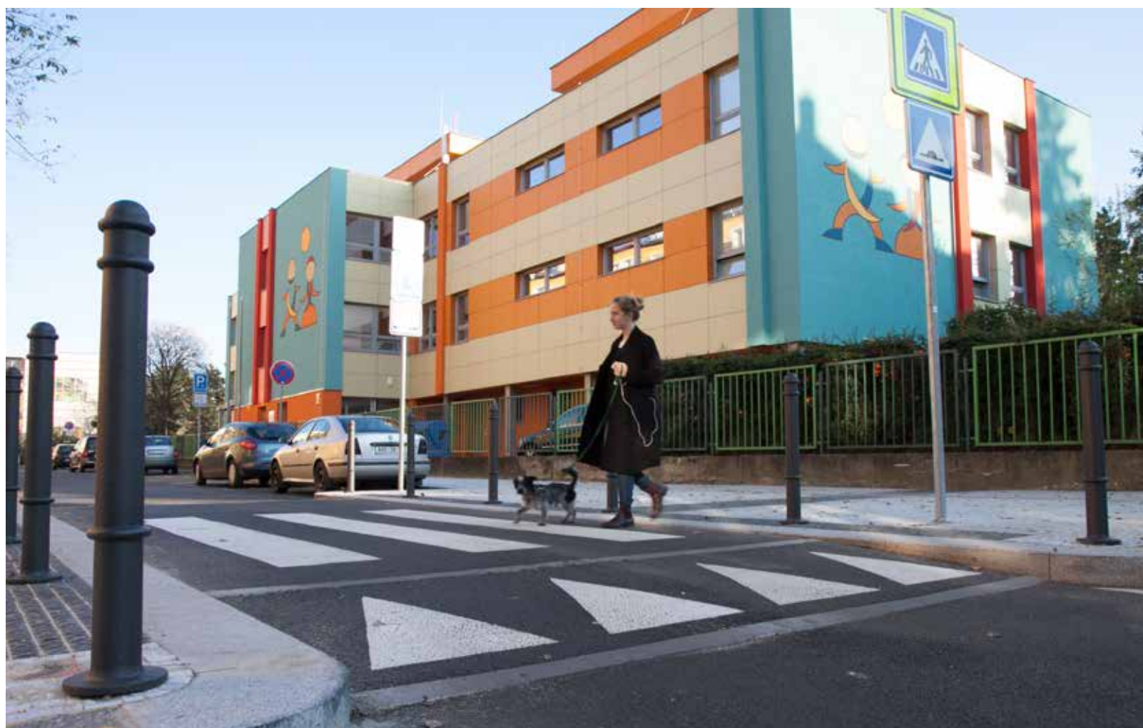
Vlevo: modernizovaný přechod s integrovaným zpomalovacím prahem zklidňuje od září dopravu před mateřskou školou v Jeseniově ulici. Nahoře: nově upravená křižovatka ulic Jičínská, Korunní a Šrobárova.
